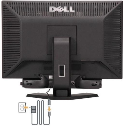
1. 從顯示器背面連接，將SoundBar與顯示器背面下方的兩個插槽與垂片對齊，然後將之連接至顯示器上。
