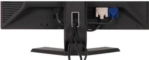
將所有必要的連接纜線連接至顯示器與電腦之後，（請參見[連接您的顯示器](#)以取得連接線的連接資訊，）請如上圖所示使用連接線固定器來將連接線整理乾淨。
